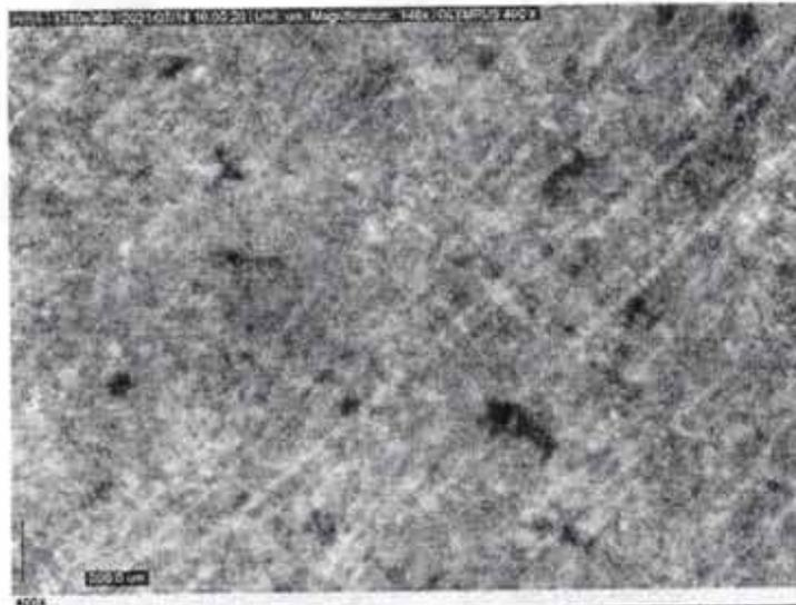
**Estrutura:** Composta por matriz bainítica com áreas de martensita, não sendo observado a presença de austenita retida. **Ataque Nital 2%. Ampliação: 400x**
