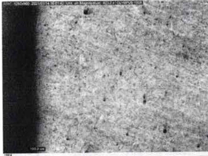
**Estrutura:** Composta por matriz bainítica com áreas de martensita, não sendo observado a presença de austenita retida ou descarbonetação superficial.
