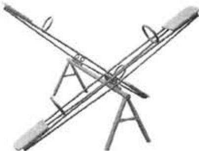
**Modulo GANGORRA 2 PRANCHAS (4LUGARES)** Estrutura do cavalete, confeccionada com tubo de 2 polegadas, chapa medindo 2,25mm medindo 2,00mt de largura, gangorra feita com tubo 1" e 7/8", com reforço embaixo medindo 1,30x2,00m de comprimento, . A pintura dos tubos deverá ser pelo sistema eletroestático com tinta a pó no mínimo três cores. Deverão obedecer aos requisitos da norma vigentes.
