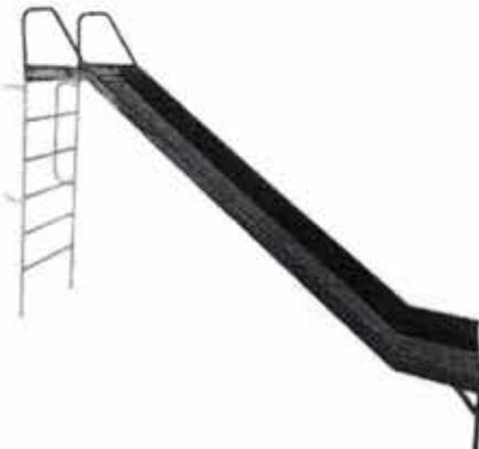
**Modulo deslizante** c/ 2,00m., confeccionado em chapa de aço galvanizada nr. 16., com corrimão em tubo de 3/4", escada e degraus com chapa de aço galvanizada nr. 16 com corrimão em tubo de 7/8", . Com uma escada medindo 1,50mt com 5 degraus e leito deslizante 2,00x0,33 cm.,. A pintura dos tubos deverá ser pelo sistema eletroestático com tinta a pó no mínimo três cores. Deverão obedecer aos requisitos da norma vigentes.
