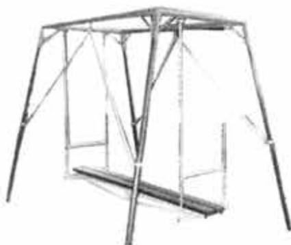
**Modulo Lambretinha** : Composta por 02 pranchas sustentadas por correntes elo de 5mm., quadro em tubo de 2" parede 2,25mm., pés em tubo de de 1.1/2", medindo 3,00x1,50m. Lambretinha confeccionada em tubo 1" e 7/8", medindo 0,80x0,20cm. Com revestimento em madeira ou chapa de pead. A pintura dos tubos deverá ser pelo sistema eletroestático com tinta a pó no mínimo três cores. Deverão obedecer aos requisitos da norma vigentes.
