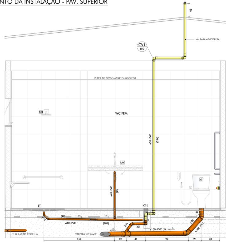
**6 DETALHAMENTO DA INSTALAÇÃO - PAV. SUPERIOR**
