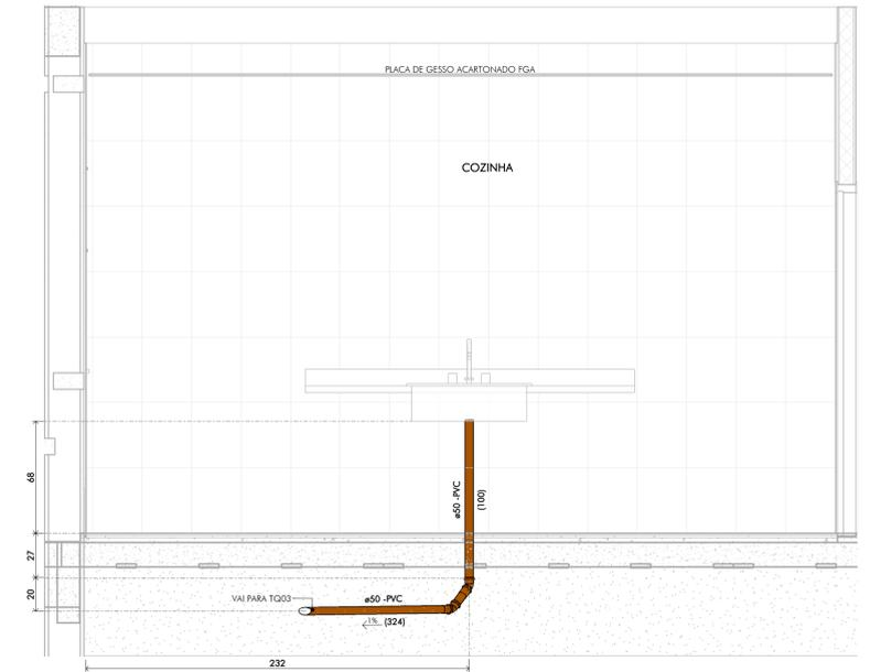
**4 DETALHAMENTO DA INSTALAÇÃO - PAV. SUPERIOR**
