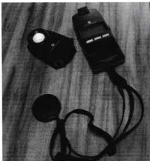
Figura 6 – Luxímetro Minolta – T-10A utilizado nas medições de campo
