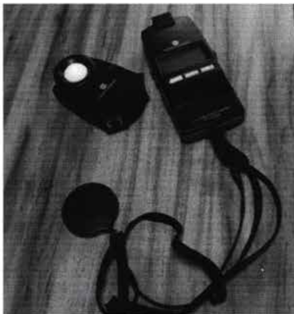
Figura 5 – Luxímetro Minolta – T-10A utilizado nas medições de campo
