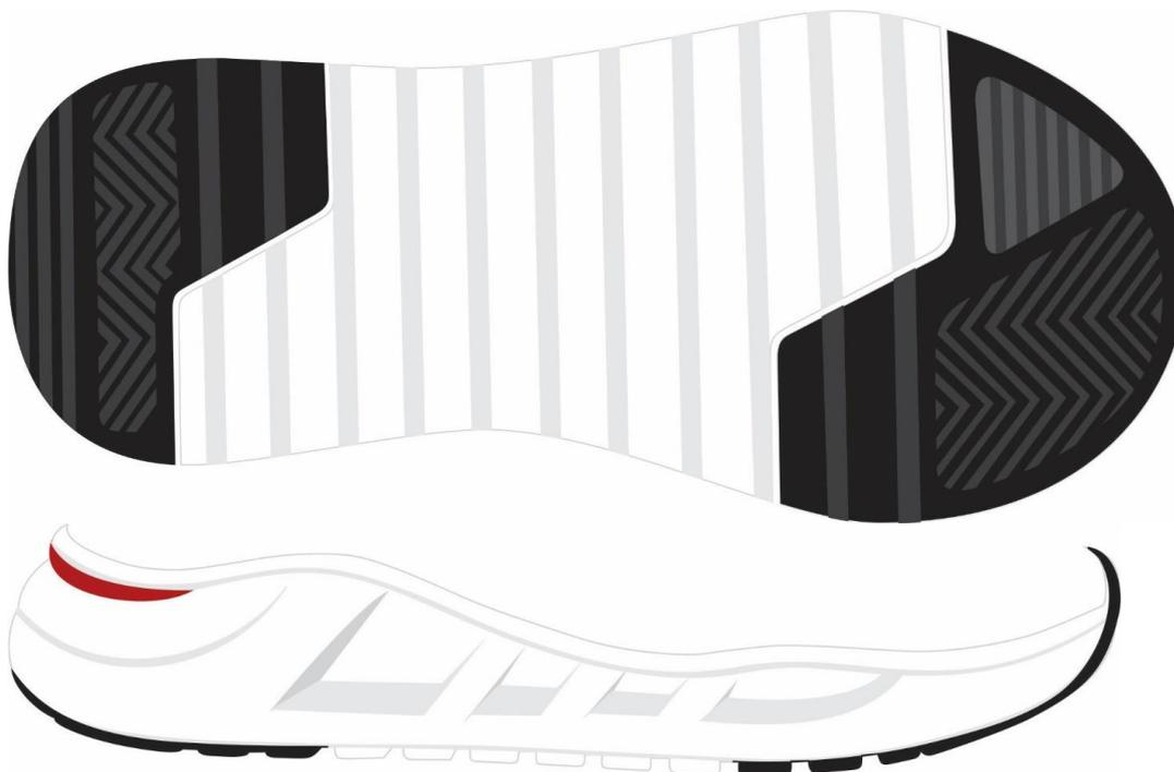
1. **ENTRESSOLA** – peça macia com amortecimento de impactos com cortes aerodinâmicos na parte externa,
